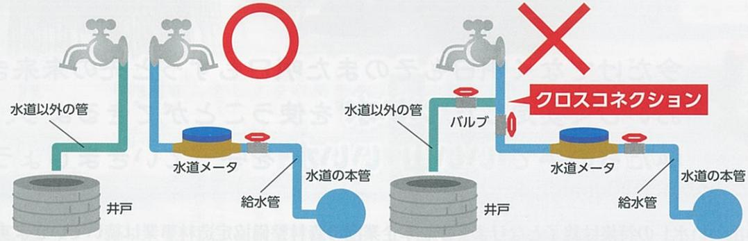
て、速やかに水道の給水管と水道以外の管を切り離してください。
