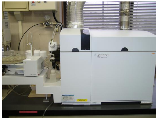
金属類の測定に使用する誘導結合プラズマ質量分析装置
